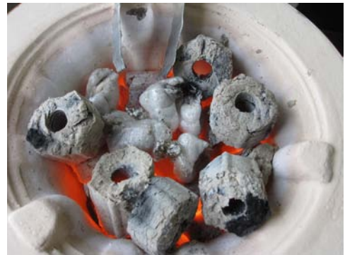
図 6. 七輪の中で発泡した黒曜石（写真中央）。
