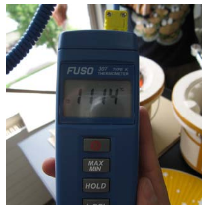
図5. 1100^{\circ}\text{C} 以上を示している温度計。
