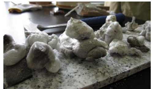
図 7. 七輪から取り出した黒曜石。発泡した様子を観察することができる。
