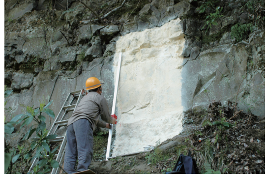
図 2. 溶岩露頭の型取り作業の様子. 剥がし取った雌型からレプリカ（型取り模造）の製作を行う。
